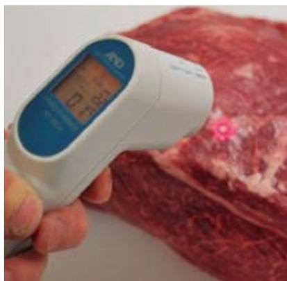
表面温度をセンサーで計測する
